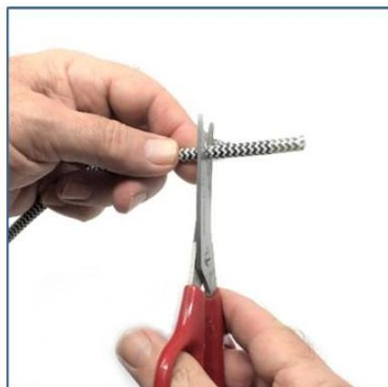
Con una forbice incidere il rivestimento tessile e quello sottostante in Pvc facendo attenzione a non tagliare i cavi interni.
